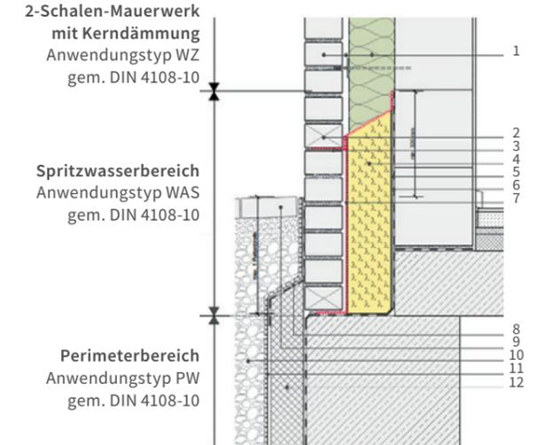
**Sockeldetail mit nichtbrennbaren WDVS-Mineralwolle-Dämmplatten ohne Perimeterdämmung**
