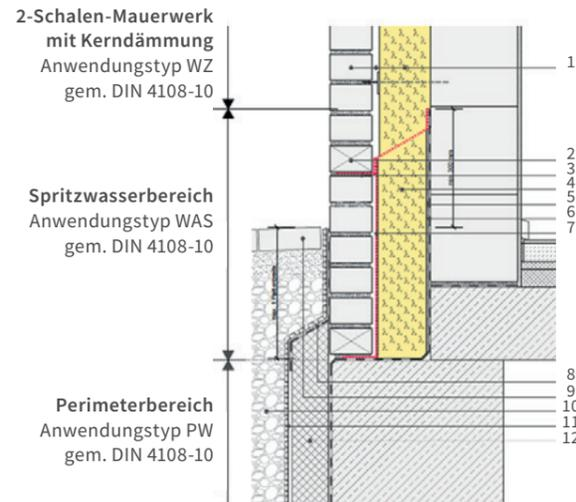
**Sockeldetail: Vorgehängte hinterlüftete Fassade mit Mineralwolle-VHF-Dämmung und PU-Sockeldämmung**
