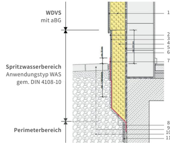
**Sockeldetail: Zweischalenmauerwerk mit Mineralwolle-Kerndämmung und PU-Sockeldämmung**
