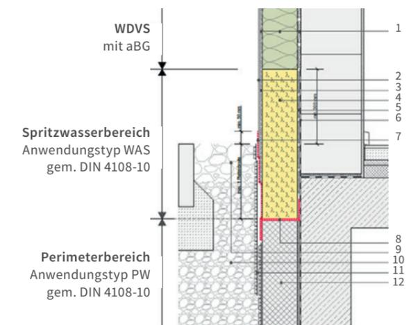
**Sockeldetail mit PU-Wärmedämm-Verbundsystem (WDVS) ohne Perimeterdämmung**
