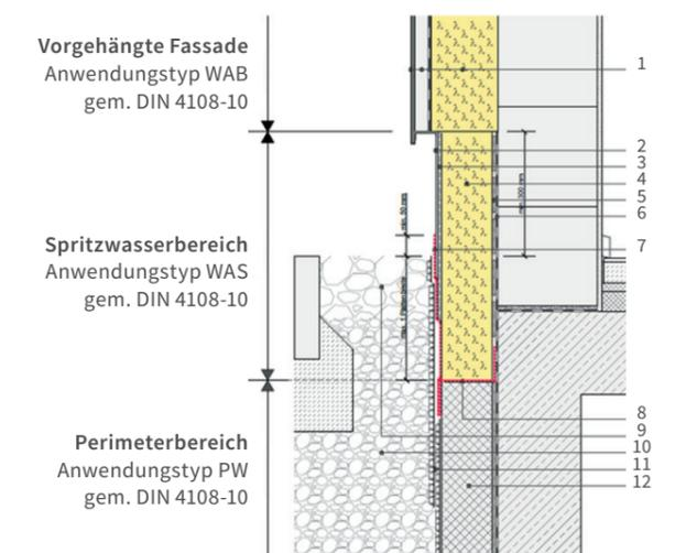
**Sockeldetail: Zweischalenmauerwerk mit PU-Kerndämmung und PU-Sockeldämmung**
